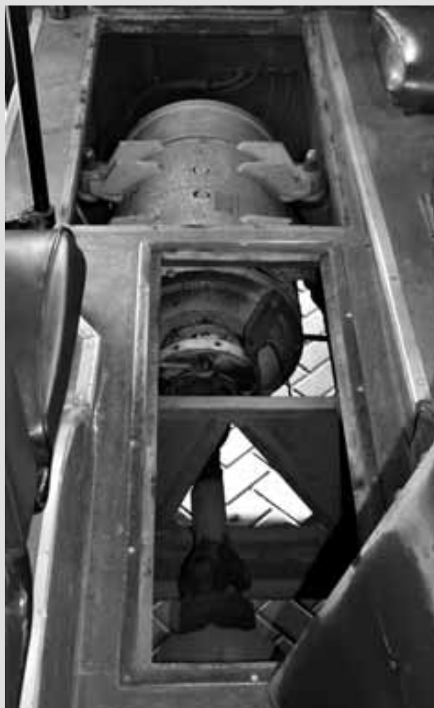
Fot. 7.14.5. Umiejscowiony wzdłużnie, za tylną osią, silnik trolejbusu. Fot. Jacek Pudło, 2011
