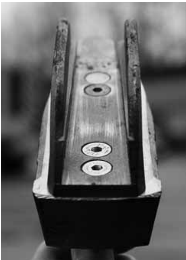
Fot. 1.1.4 Rynienka na wkład grafitowy. W tym miejscu umieszczany jest podłużny wkład grafitowy, umożliwiający cierną współpracę przewodu jezdnego i odbieraka Fot. Jacek Pudło
