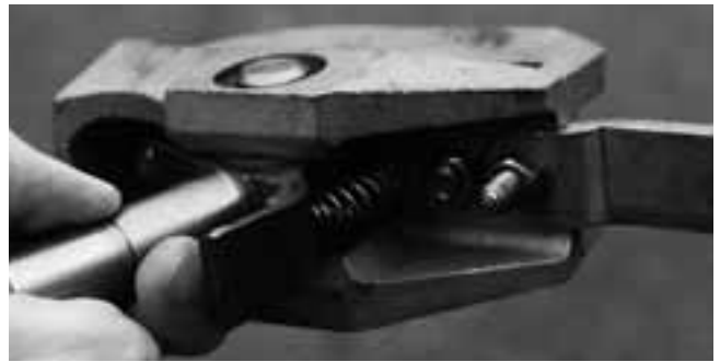
Fot. 1.1.3 Głowica widziana od dołu, od strony zamocowania do końcówki drążka odbieraka. Sprężyna widoczna po prawej dociska głowicę do sieci jezdnej Fot. Jacek Pudło
