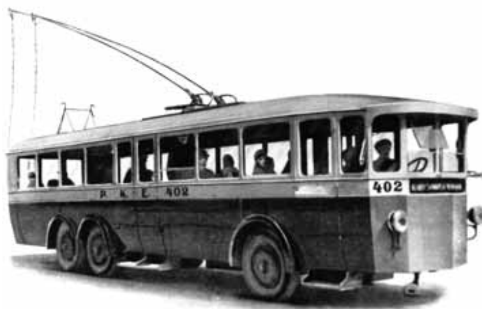
Fot. 2.1. Trolejbus poznański z początku lat 30. Trzyosiowa, nietypowa w Polsce konstrukcja była jednym z typów spotykanych w jedynej istniejącej w Polsce przed II wojną światową sieci trolejbusowej. Zdjęcie ze zbiorów Harald'a Neise
