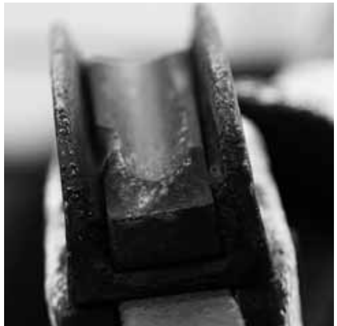
Fot. 1.1.5 Głowica w stanie używanym. Wkład grafitowy posiada fabrycznie niewielkie, półokrągłe, podłużne zagłębienie, które widoczne jest na zdjęciu. Do zużycia grafitowego wkładu doprowadzają wspólnie tarcie oraz iskrzenie podczas przejazdu przez elementy izolowane sieci trakcyjnej Fot. Jacek Pudło
