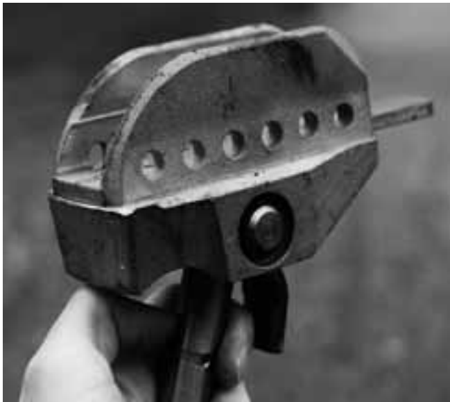
Fot. 1.1.2 Widok boczny na głowicę odbieraka. Na środku kadru widoczny sworzeń, umożliwiający obrót głowicy wokół osi poprzecznej. Głowca na zdjęciu pozbawiona jest grafitowego wkładu. Język z tyłu, widoczny po prawej stronie kadru, utrudnia wypadnięcie głowicy z sieci przy pokonywaniu łączeń przewodu Fot. Jacek Pudło
